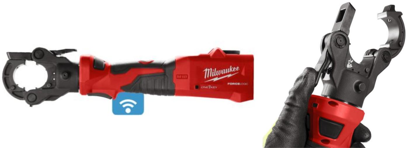
La sertisseuse hydraulique FORCE LOGIC™ sertit des cosses électriques en cuivre et en aluminium en moins de 3 secondes avec une force de sertissage de 60 kN
